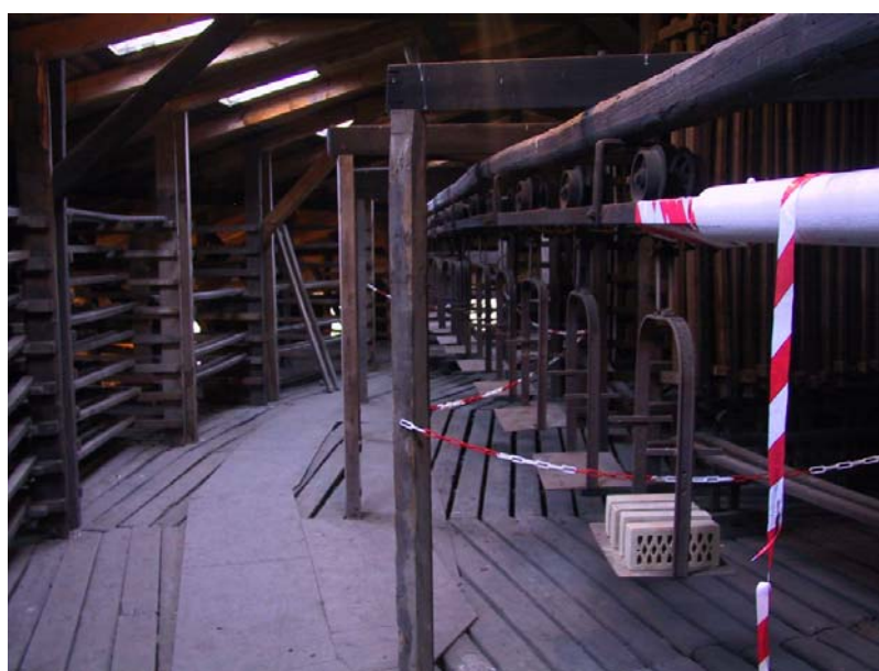
36 Tørreloft med reoler til stenene samt transportbånd.
